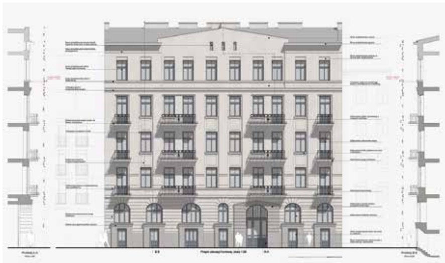
Kamienica przy ul. Wroniej 52 (1912), elewacja od ulicy z rekonstrukcją utraconej w 1944 r. ostatniej kondygnacji oraz partii zwieńczenia i dachów. Oprac. H. Przybyszewski (2021) w ramach przedmiotu Projekt przeddyplomowy (sem. 11) na Wydz. Architektury Politechniki Warszawskiej pod kier. P. Kilanowskiego
