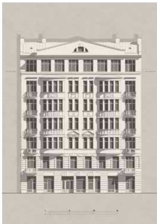
Kamienica przy ul. Próźnej 12 (1912), elewacja od ulicy z rekonstrukcją utraconej w latach 1944-1946 ostatniej kondygnacji oraz partii zwieńczenia i dachów. Oprac. H. Przybyszewski (2024)
