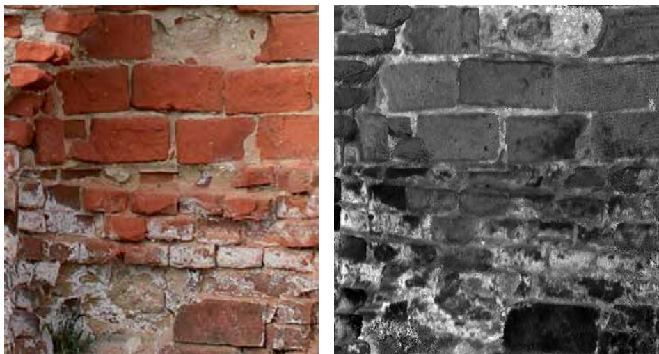
Ryc. 3.24. Iłża, fragment ruin zamku górnego. Porównanie fragmentu lica muru (po lewej) barwne zdjęcie cyfrowe oraz (po prawej) obraz intensywności odbicia wiązki lasera. Różnice wartości intensywności dla cegieł wynikające z istniejących wykwitów soli, zawilgocenia oraz zróżnicowania powierzchniowego (ubytki – uszkodzenia mechaniczne). (oprac. fotogram. Politechnika Warszawska)
