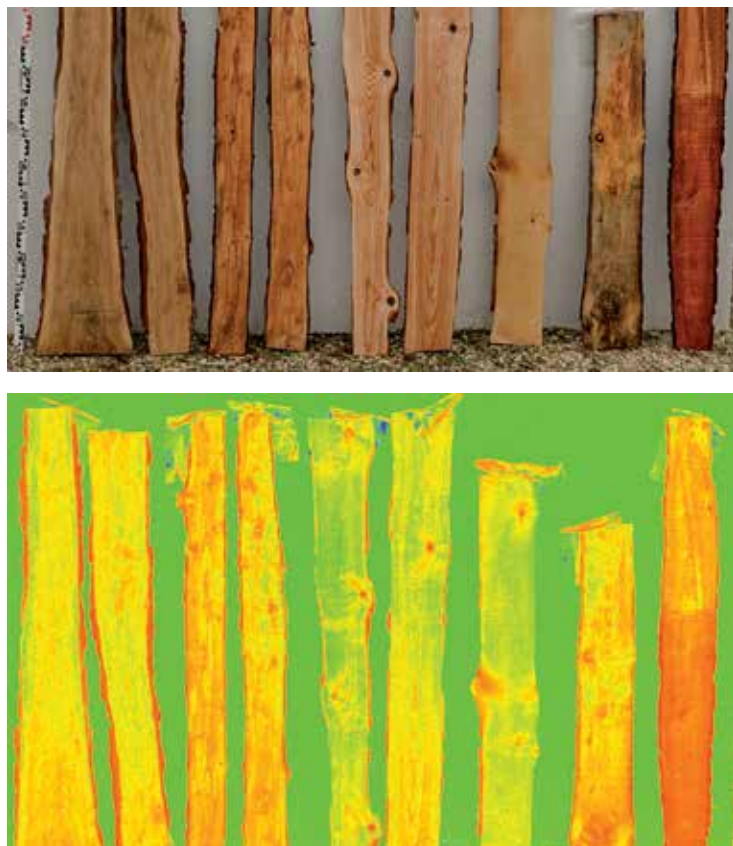
Ryc. 3.31. Próbki (nawilżone wodą) różnych gatunków drewna (góra) i obraz zróżnicowanej intensywności odbicia wiązki lasera (dół) (pomiar Leica Geosystems / oprac. R. Zapłata)
