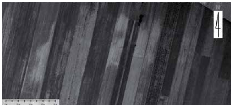
Ryc. 5.23. Wizualizacja fragmentu z gęsto występującym na powierzchni terenu rozdrobnionym wapieniem. Wartość intensywności odbicia wiązki lasera dla poszczególnych miejsc (przybliżona średnia wartość) – (jasny odcień) 140 / po prawej (ciemny odcień) 40 (pomiar MGGP Aero / oprac. R. Zapłata)
