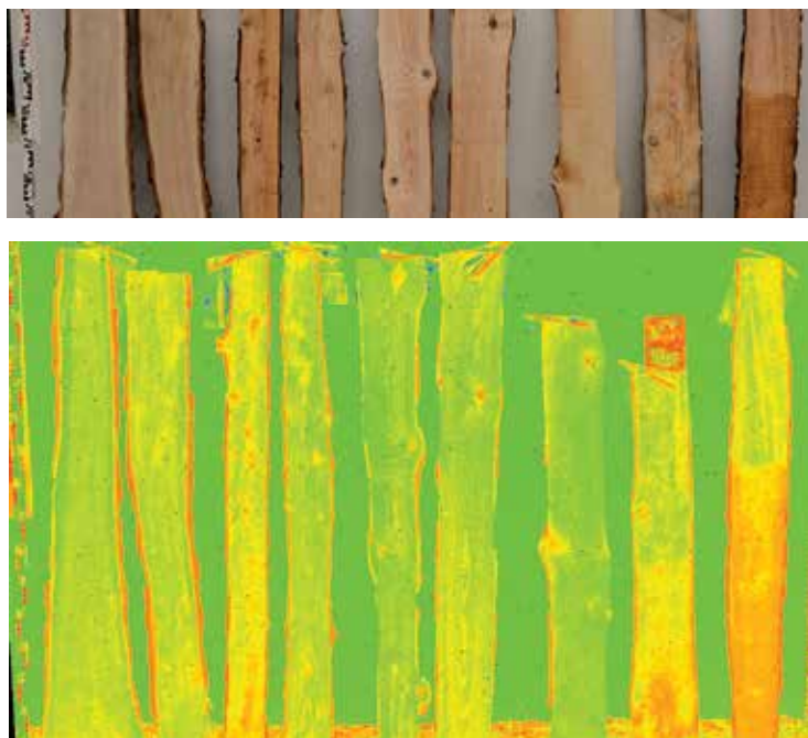
Ryc. 3.30. Próbk (suche) różnych gatunków drewna – zdjęcie na górze i obraz zróżnicowanej intensywności odbicia wiązki lasera – na dole (pomiar Leica Geosystems / oprac. R. Zapłata)
