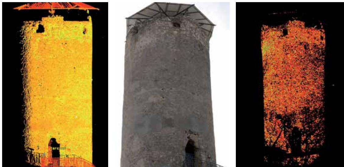
Ryc. 3.23. Iłża – ruina zamku. Rejestracja intensywności odbicia wiązki lasera dla powierzchni wieży zamkowej. Skaner Leica P10 (1 – po lewej) odległość ok. 30 m, (3 – środek) wieża zamkowa widok od NW (podobnie jak skany), (3 – po prawej) odległość skanowania ponad 100 m (poza zasięgiem dla skanera fazowego Z+F). Z bliższej odległości rejestrowane wyraźne różnice dla nieotynkowanego piaskowca w górnych partiach wieży (pomiar Leica Geosystems / oprac. R. Zapłata)
