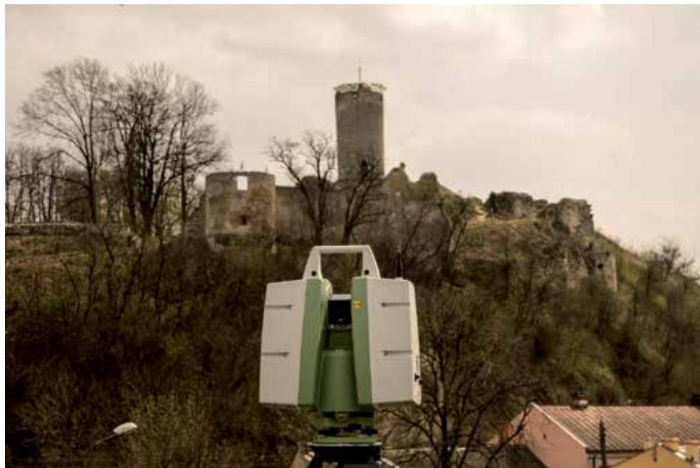
Ryc. 2.1. Naziemny skaner laserowy (skaner impulsowy – Leica ScanStation C10) podczas pomiarów ruiny zamku w Ilży (fot. R. Zapłata)
