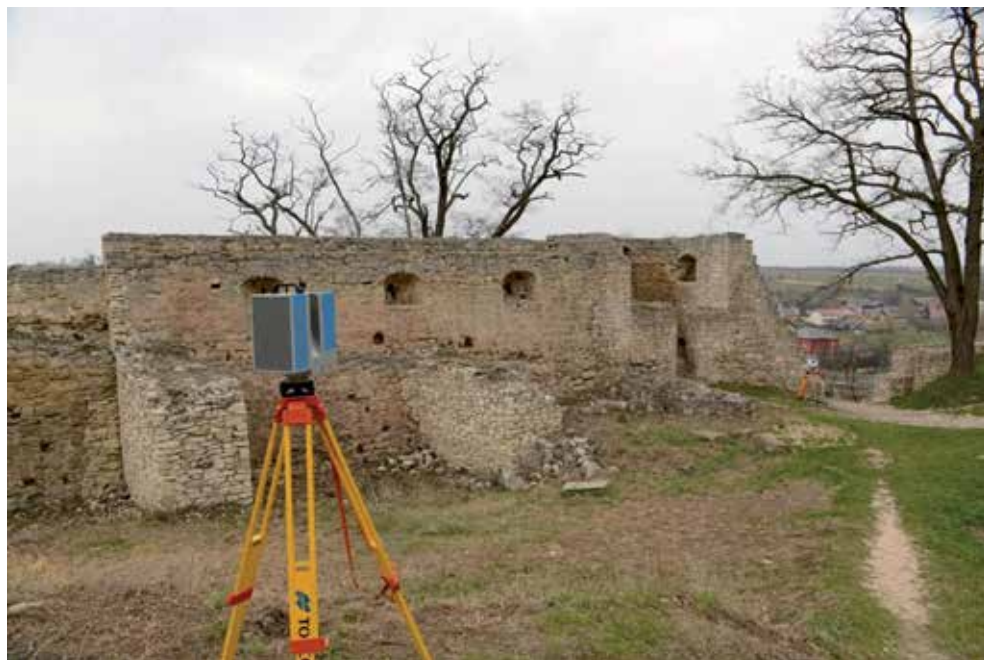
Ryc. 2.2. Naziemny skaner laserowy (skaner fazowy – Z+F IMAGER 5006) podczas pomiarów ruiny zamku w Iłży (fot. R. Zapłata)
