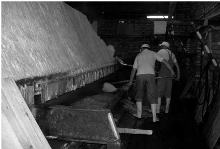
11. Technologia pozyskiwania soli nie zmieniła się od prawie 180 lat. Warzelnicy używają łopat, „kosiorków” i „dziadów”. Fot. A. Nocna
