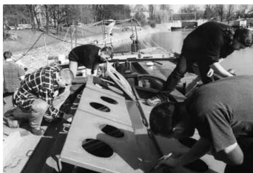
16. Odbudowa świetlików maszynowni HP „Nadbor”, 2000 r. Fot. S. Januszewski
