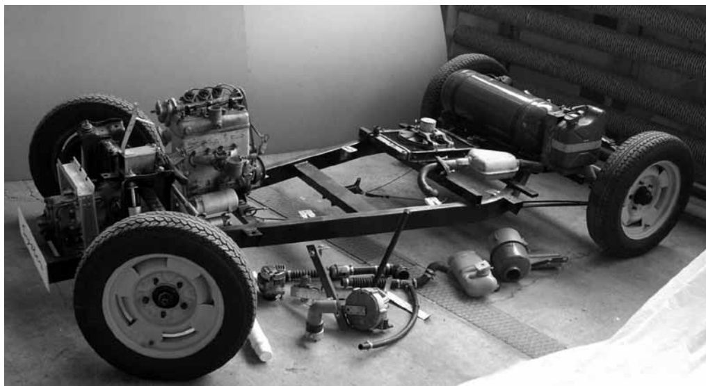
9. Podwozie samochodu Syter przygotowane do montażu instalacji dwupaliwowej
