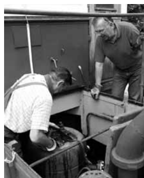
9. Kpt. Mieczysław Balcerkiewicz i inż. Wojciech Śladkowski prowadzą próbę wodną, ciśnieniową kotła parowego HP „Nadbor”, 2009 r. Fot. S. Januszewski
