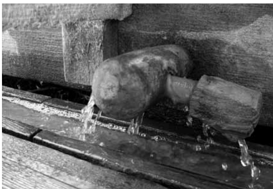
9. Przepływ solanki z głównego koryta do korytka bocznego, które przenosi strumień wody na ciernie.
